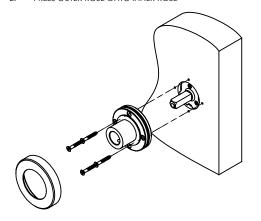
SECURE LEVER TO SPINDLE USING M6 PIERCING GRUB SCREW
