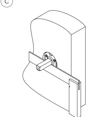
ENSURE THAT DUMMY SPINDLE IS AT 90° TO DOOR EDGE
